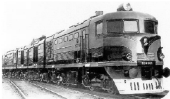
Рис. 11. Газогенераторный магистральный трехсекционный тепловоз ТЭ4
