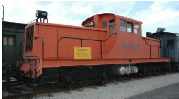
Рис. 6. Экспериментальный локомотив Plymouth ML с газопоршневым двигателем (1937 г.)
