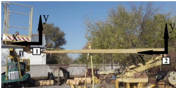
Рис. 4 Точки встановлення двокоординатних акселерометрів
