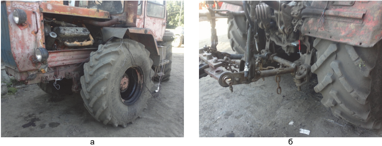
Рис. 3. Установка датчиков МРИК на шарнирно-сочлененной машине: а – на передней секции; б – на задней секции
